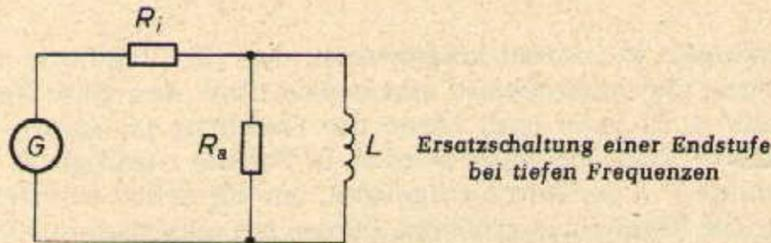
der gleich dem mit dem Quadrat des Übersetzungsverhältnisses  $\ddot{u}$  multiplizierten Widerstand des Lautsprechers ist. Da es sich hier um Wechselspannungen handelt, sind die Widerstände komplex zu nehmen. Wenn wir nach der Frequenz  $f$  fragen, bei der die Spannung am Lautsprecher um 3 dB gegenüber dem Wert bei mittleren Frequenzen abgenommen hat, erhalten wir
